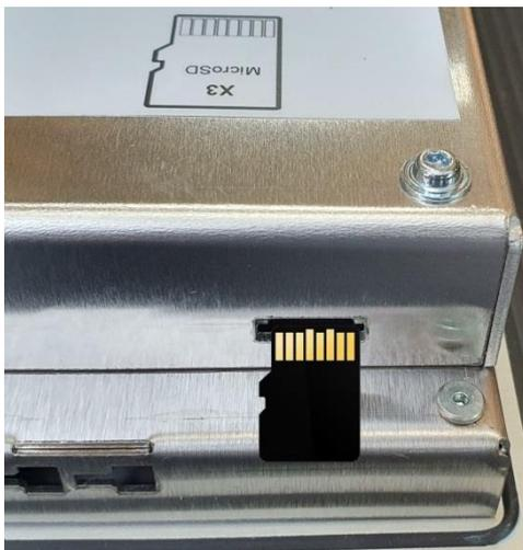
Die microSD-Card ist mit Kontakten nach hinten (Richtung Geräterückseite) gemäß obiger Abbildung einzulegen.
