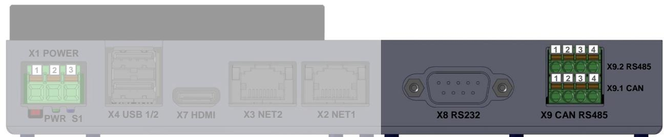
Bild 5: Schnittstellen/Stecker Erweiterungsteil Rückseite des Modells CU 5x-2x1x
