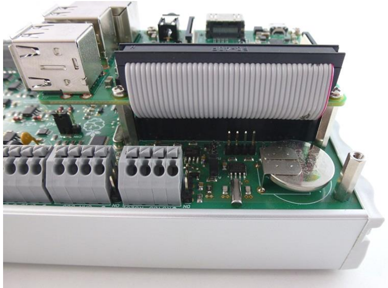
Abbildung 45: Verbindung zwischen PiXtend V2 -L- und Raspberry Pi
