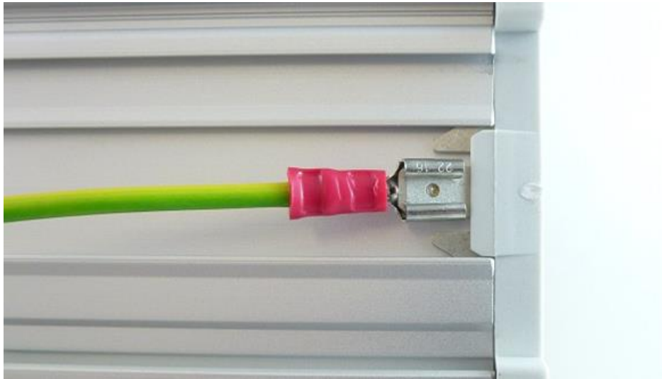
Abbildung 16: Hutschiengehäuse - Schutzleiter (PE) angeschlossen
