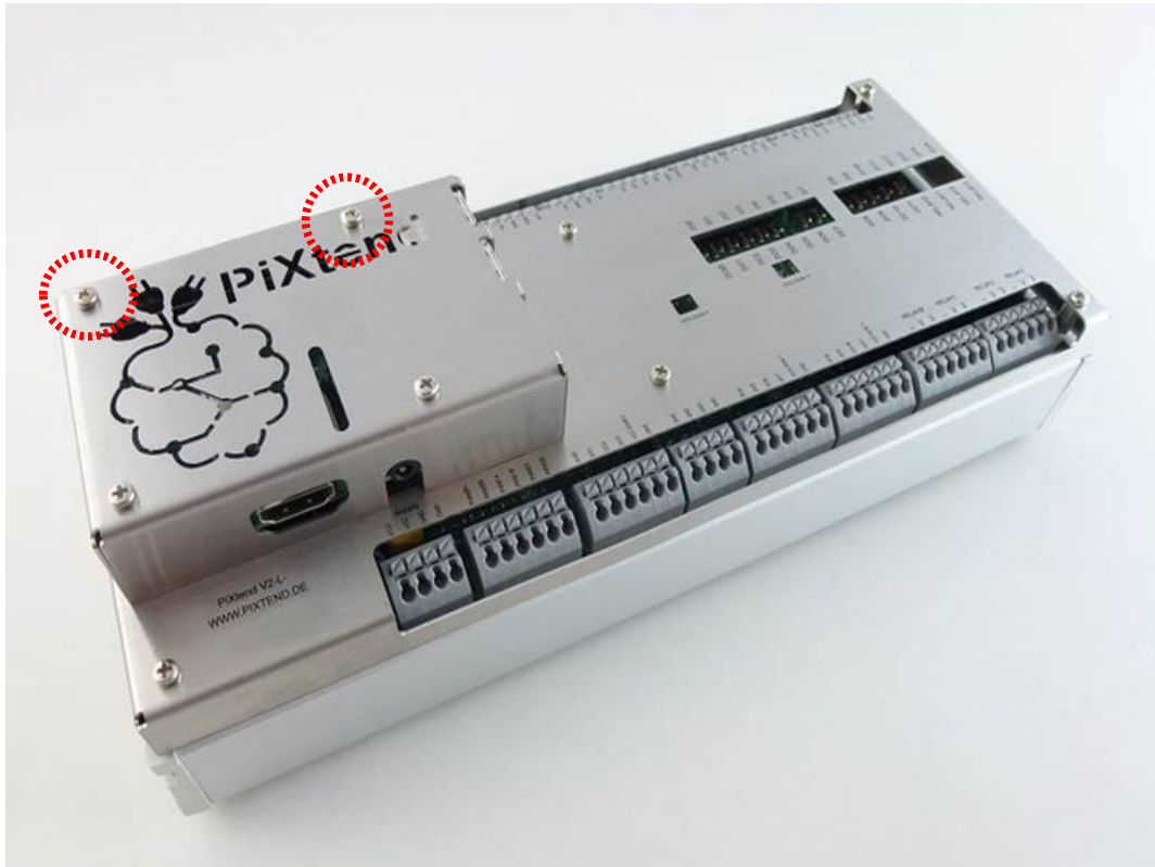
Abbildung 26: Edelstahlhaube fertig montiert
