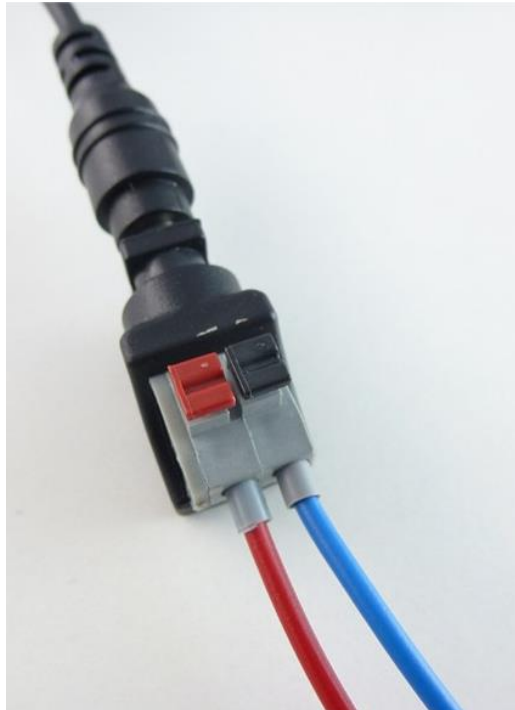
Abbildung 38: Anschluss der Leitungen an den Adapter
