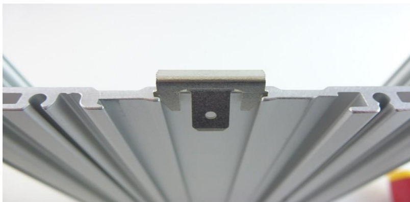
Abbildung 9: Erdungskralle einsetzen (vor dem Einpressen)
