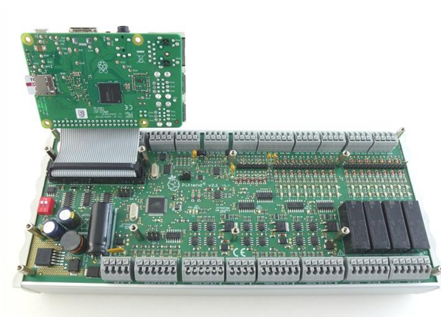
Abbildung 19: Raspberry Pi von PiXtend gelöst (Flachbandkabel bleibt verbunden)
